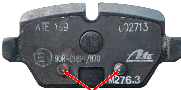
Abdrücke des Bremskolbens aufgrund fehlerhafter Montage
